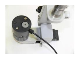
Neue LED-Einheit aufsetzen – drehen bis zum Einrasten
