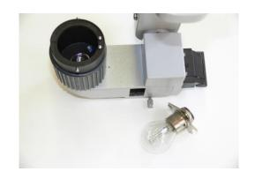
Oberes Glühlampengehäuse abdrehen - Glühlampe entnehmen
